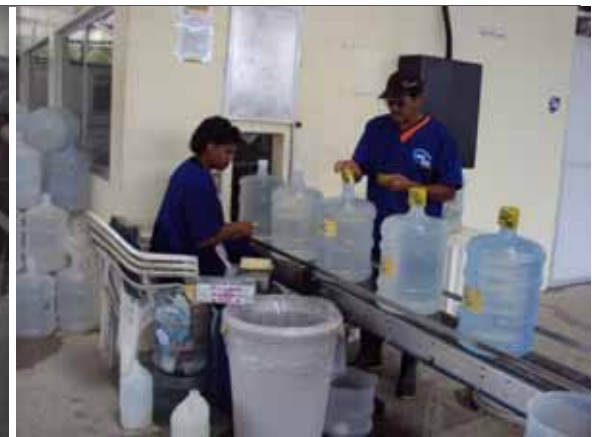
Foto 26 – Saída dos Garrafões do envase por esteira para a rotulagem
