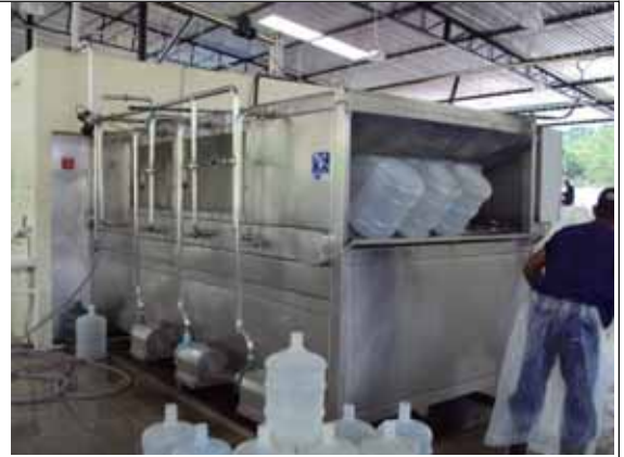
Foto 22 – Entrada dos garrafões na máquina mecanizada para limpeza
